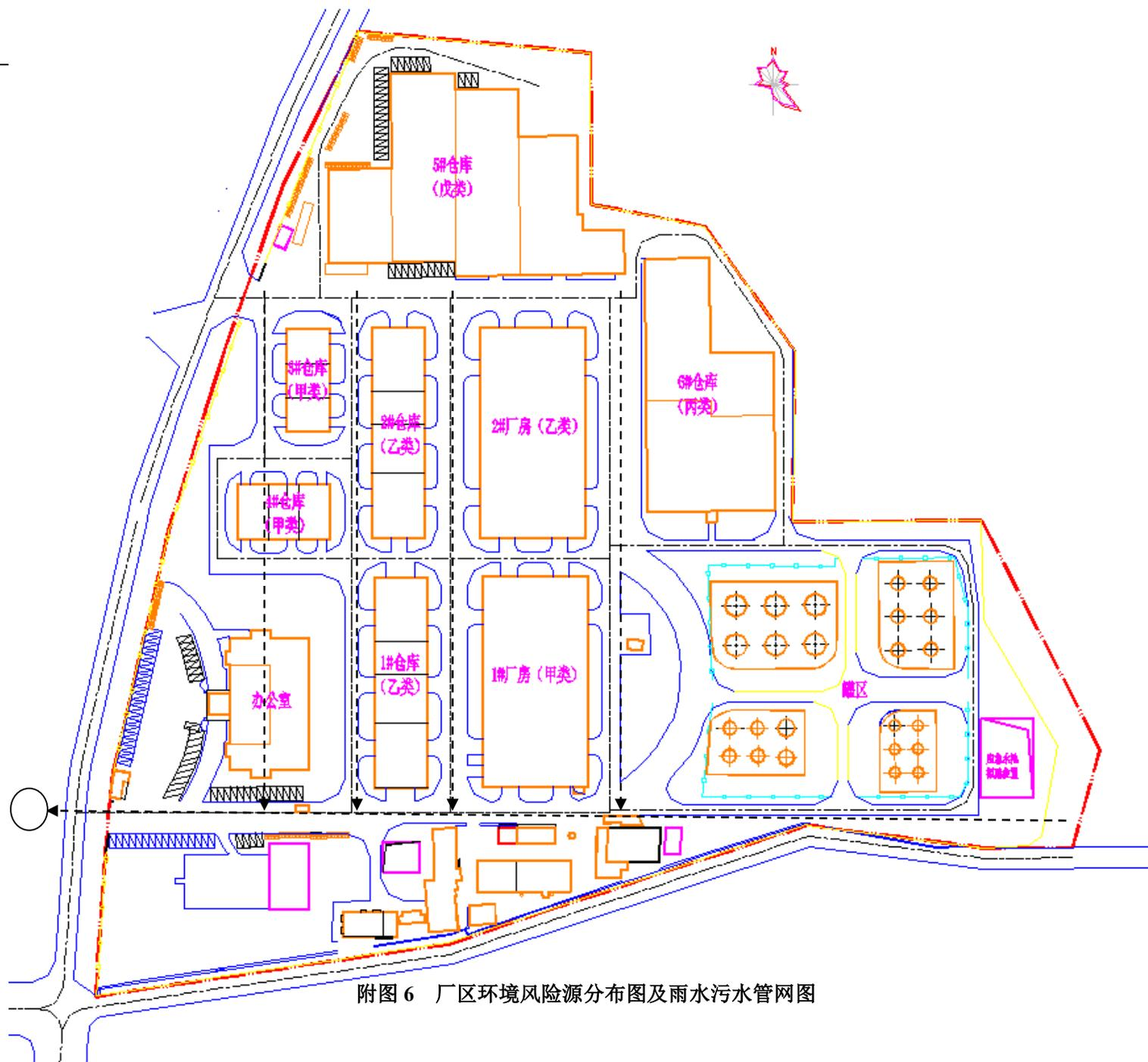
附图 6 厂区环境风险源分布图及雨水污水管网图
